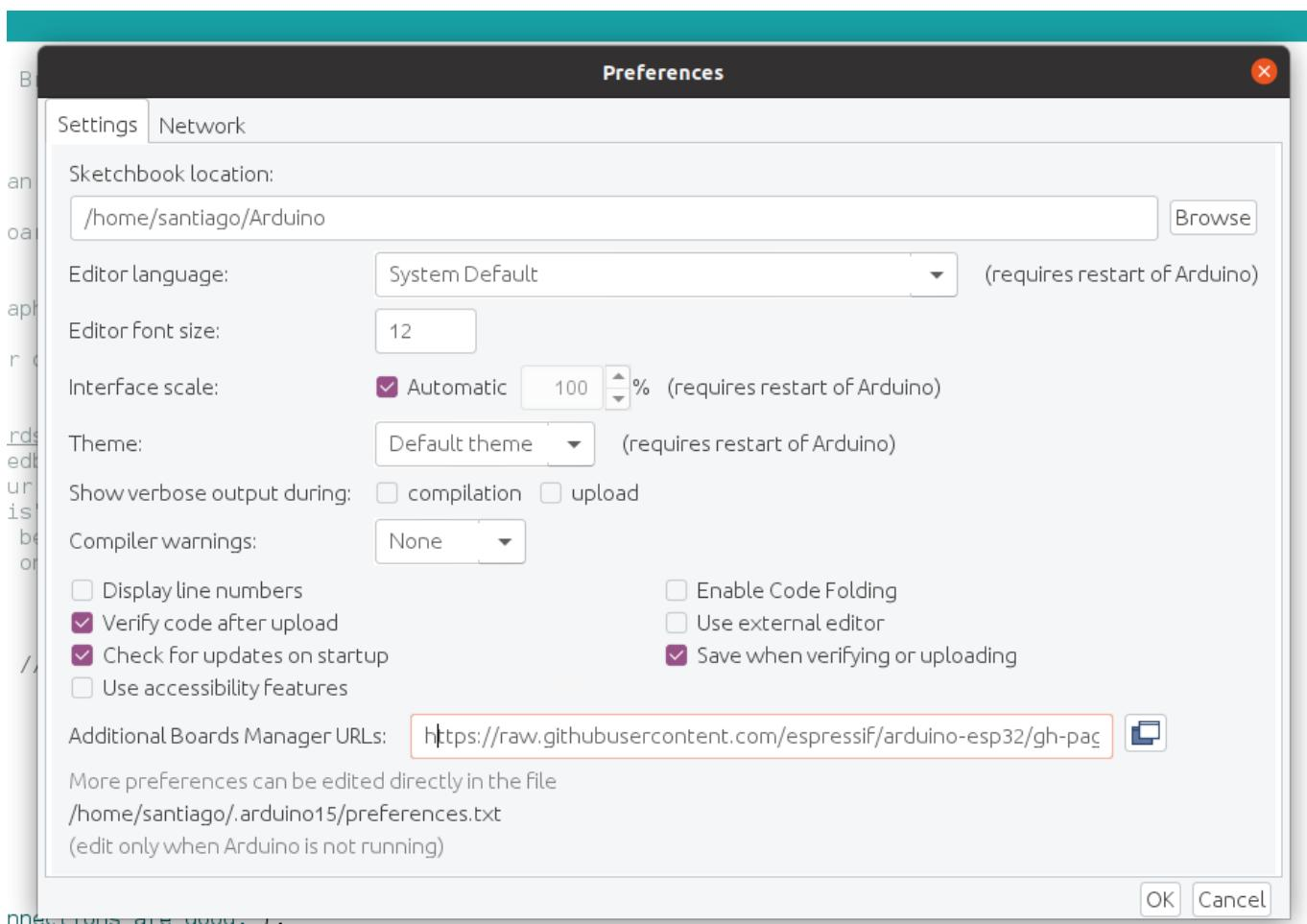
Pulsamos el botón ok, en el apartado de herramientas, placas, seleccionamos el administrador de placas (board manager), buscamos por esp32 y lo instalamos. Una vez instalado, en el apartado de placas debe aparecer ESP32 Arduino y dentro de ese apartado seleccionamos nuestra placa en concreto (en el caso de la placa ESP32 ESP-WROOM-32 NodeMCU v2 la opción ESP32 DEV Module ha funcionado correctamente).
